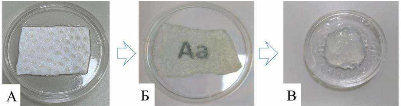
Рисунок 47 – Внешний вид образца дермы свиньи до обработки щелочным раствором (А), после 6 ч обработки 5 % NaOH (Б), после 20 ч обработки 5 % NaOH (В)
